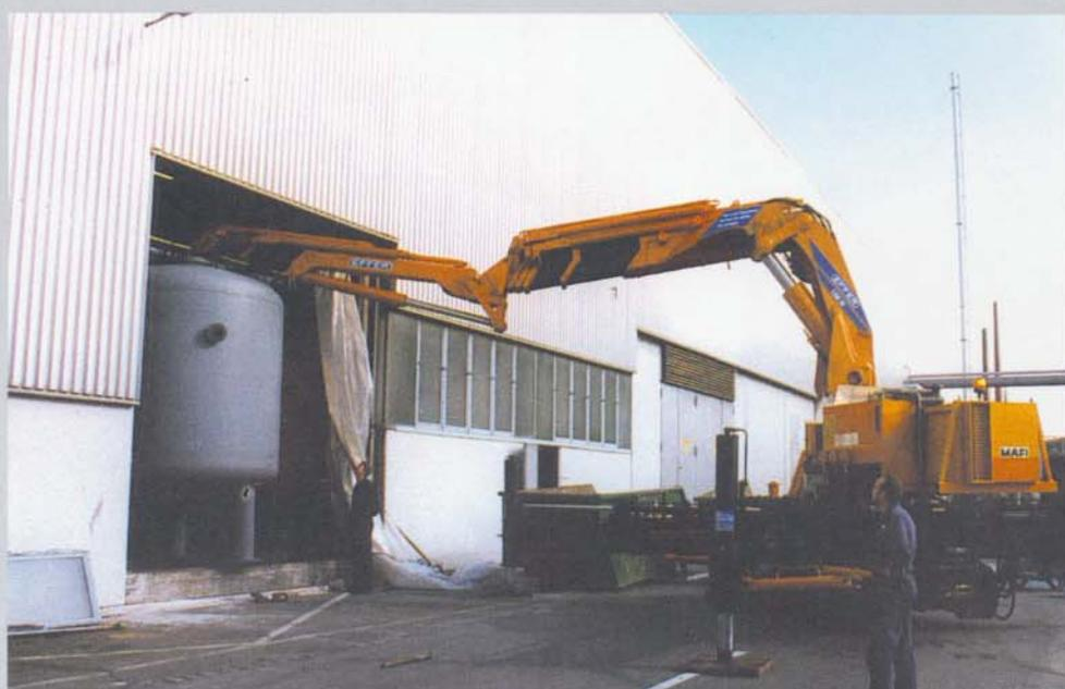
Mit dem Zusatzgelenk in Negativstellung (30°) lassen sich mühelos Lasten durch Öffnungen in der Gebäudefassade ins Halleninnere heben.
