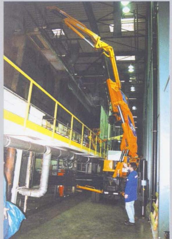
Ca. 2,7m Freiraum zwischen Arbeitsbühne und Außenwand verschaffen dem WEMB einen Schwenkradius von 180° um ein Stahlbecken anzuheben und durch eine Öffnung in der Hallenfassade nach außen zu heben.
